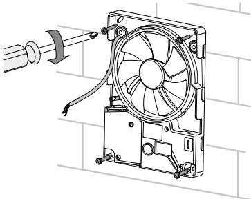
7. Зніміть кришку для доступу до клемної колодки та підключіть вентилятор до мережі відповідно до схеми підключення. Складіть вентилятор у зворотному порядку.
