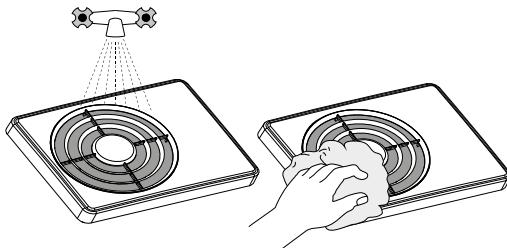
2. Зніміть лицьову панель. Очистіть лопаті вентилятора за допомогою м'якої сухої тканини або щітки.
